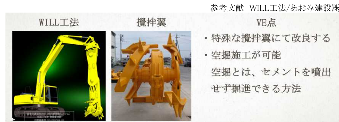
図13 WILL工法の概要
