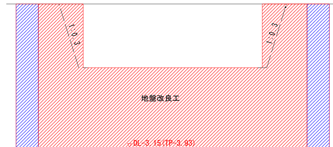
断面図(セメント添加量:青 100kg/m 3 、赤 80kg/m 3 )
