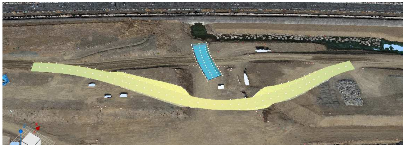
設計モデル 上;床掘 下;仮設道路
