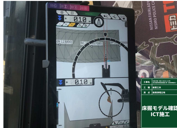
バックホウオペレーター用モニター
