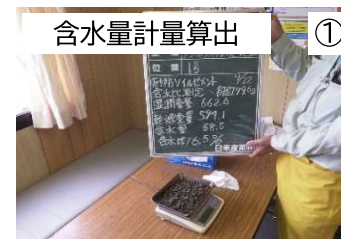
含水比試験(直接加熱法)
