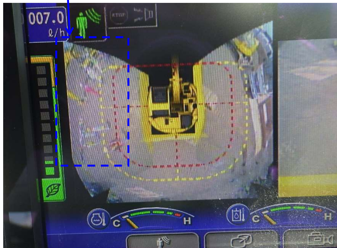
機体の側面および後方をモニターで状況確認
