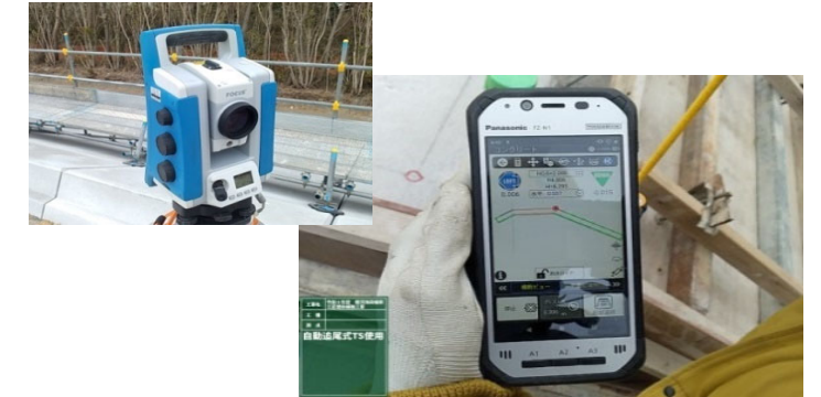
図-14: 使用機器類(自動追尾式TS+ICT施工現場端末アプリ)
