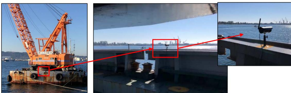
図22 起重機船前方へのワイヤレスカメラ設置状況
