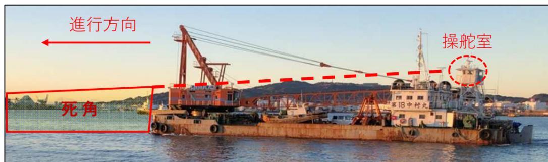
図22 起重機船操舵室からの死角イメージ図
