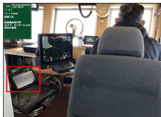
図23 操舵室へのモニター設置状況
