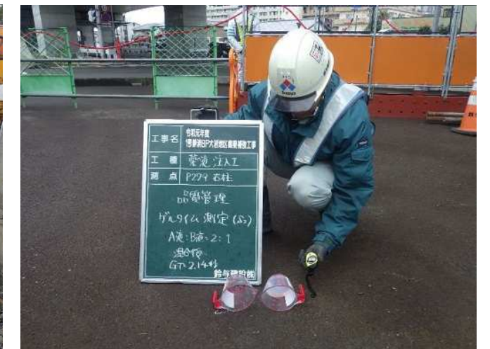
写真7 瞬結材ゲルタイム測定 2.1秒
