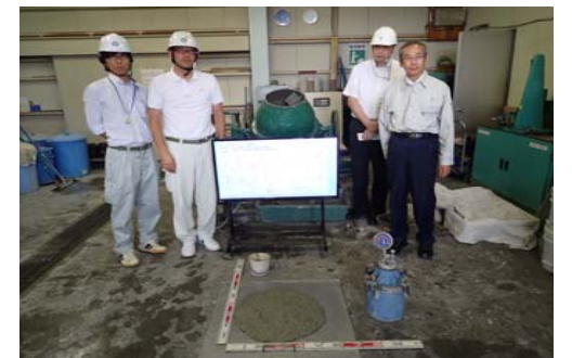
水中不分離性コンクリート試験練
