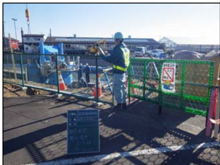
施工時敷地境界で騒音測定 計測値77.2bB < 基準値85bB
