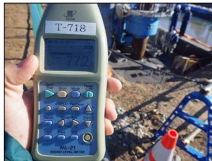
施工時敷地境界で騒音測定 計測値77.2bB < 基準値85bB
