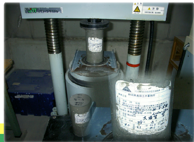
コンクリート供試体確認版確認写真
