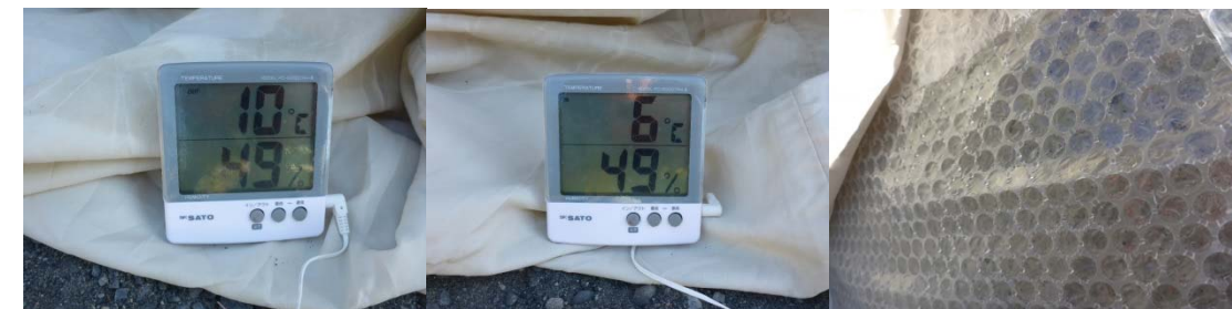
写真-14 外気と内部温度の差が4℃有り効果が期待できる
