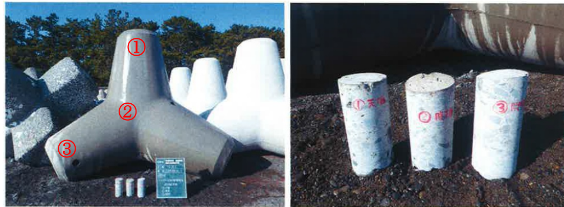
写真-15 供試体 コア採取 圧縮強度試験
