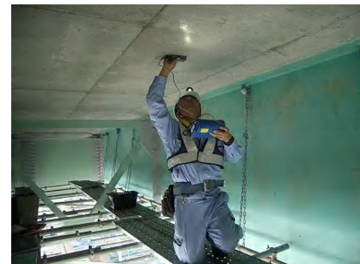
電磁誘導法による測定方法
